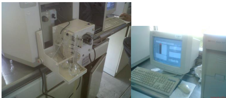
Fotografía 11.- Colocación del generador de Hidruros para la lectura de Mercurio al Equipo de Absorción Atómica y Software Spectra para la lectura de metales pesados
