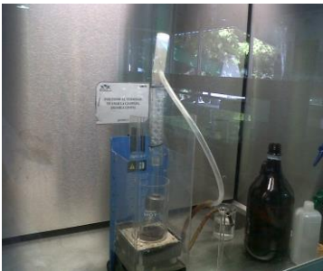
Fotografía 6.- Colocación de la muestra en Ácido Sulfúrico Concentrado para su digestión dentro de un matraz aforado de 100ml.
