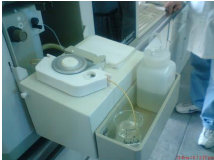
Fotografía 11.- Colocación del generador de Hidruros para la lectura de Mercurio al Equipo de Absorción Atómica y Software Spectra para la lectura de metales pesados
