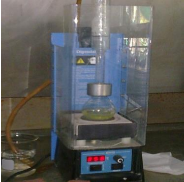
Fotografía 8.- Se agrega Peróxido de Hidrogeno para blanquear el digerido
