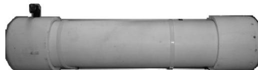
**Figura 4. Secador de Aire de entrada**
