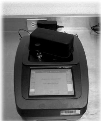
Figura 8. Espectrofotómetro Hach DR 2800
