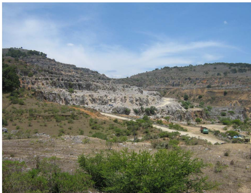
Explotación por método de banco de fosforita en el Tajo La Negra.
