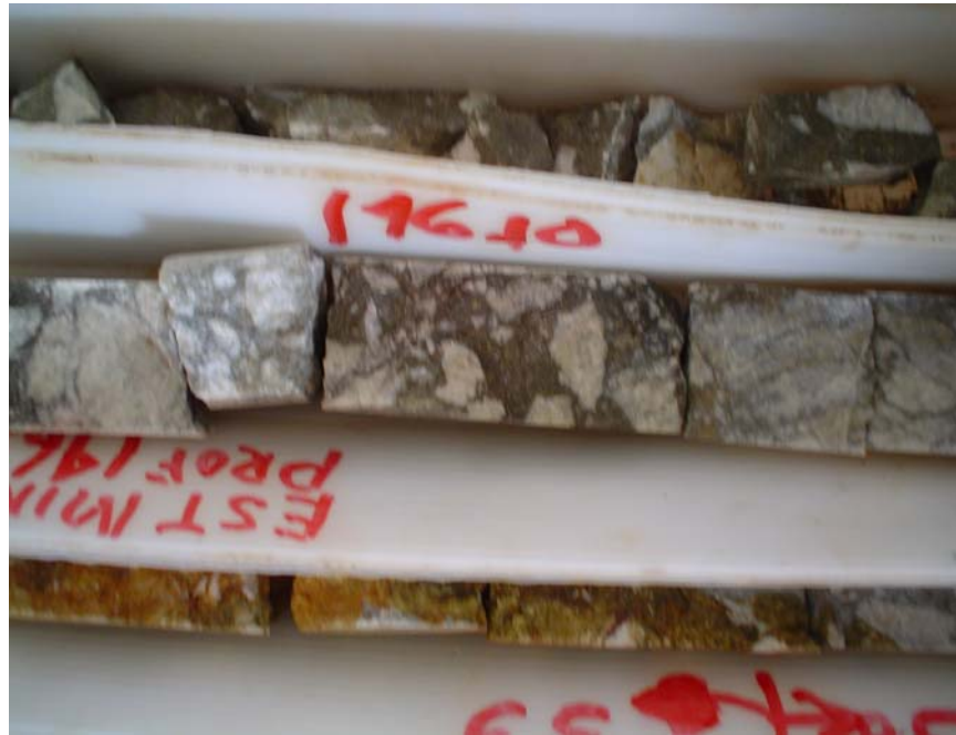
Foto 8. Brecha Mineralizada cortada por barreno de exploración.
