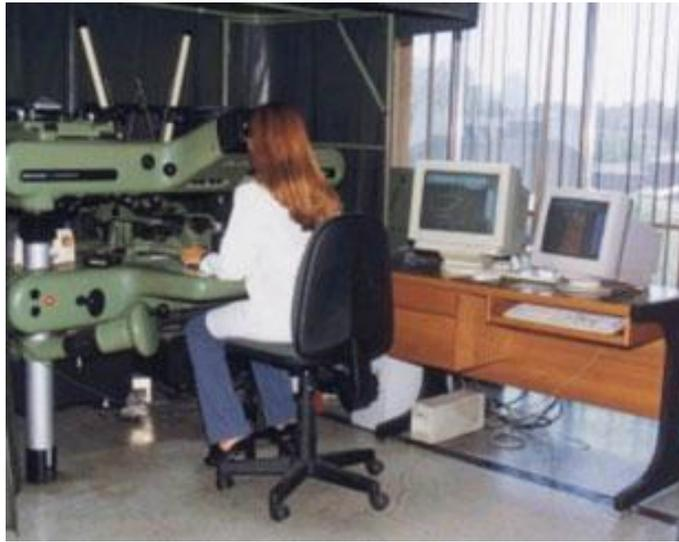
Figura No. 31.- Restitución fotogramétrica del terreno.
